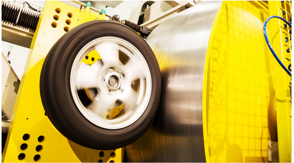
Der Reifenprüfstand erlaubt den Vergleich verschiedenster Reifenunterbauten und Laufflächenmischungen, um einen Kompromiss zwischen Langlebigkeit, Energieverbrauch (Rollwiderstand) und Reibwert zu finden. Unterschiedliche Trommeloberflächen erlauben die Simulation unterschiedlicher Fahrbahnbeschaffheiten. Foto: Nokian
