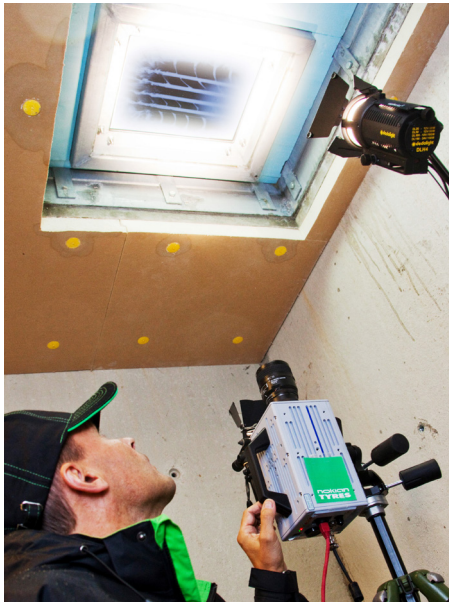
Mittels Vorbeifahrtsmessungen auf einer Glasplatte werden bei hohen Geschwindigkeiten Aquaplaning- oder Schneeverhalten untersucht. Foto: Nokian
